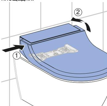
**3** Приподнимите прибор, насколько позволяет ограничитель. Очистите пространство между унитазом-биде и керамическим унитазом.
