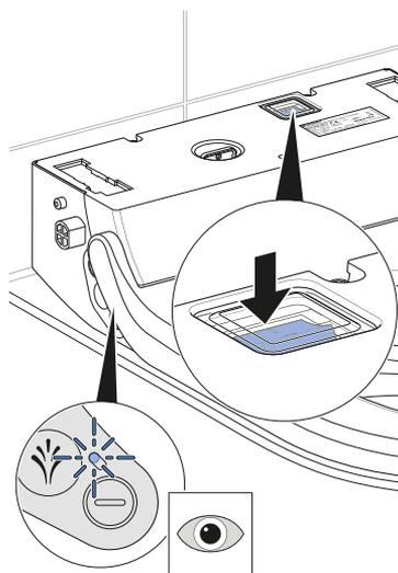
✓ Светодиод состояния на боковой панели управления мигает/гаснет.
