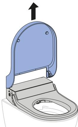
**4** Для полной очистки снимите декоративную панель.
